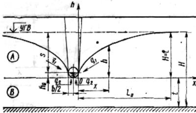
Рис. 1.2. Схема к расчету одиночной несовершенной дрены
