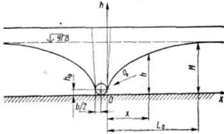
Рис. 1.1. Схема к расчету одиночной совершенной дрены
