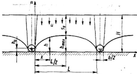
Рис. 1.4. Схема к расчету системы совершенных дрен
