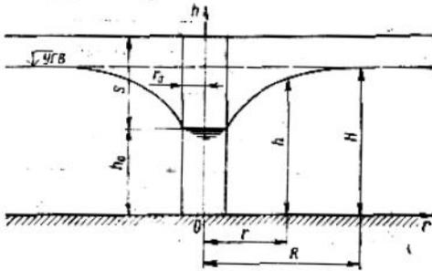
Рис. 1.5. Схема к расчету совершенного дренажного колодца (скважины)
