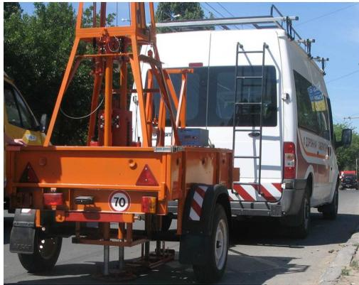
Рис. 8. Установка динамического нагружения ДИНА-3
