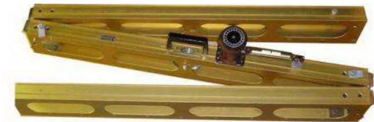
Рис. 6. Дорожная рейка "Кондор-3М"
