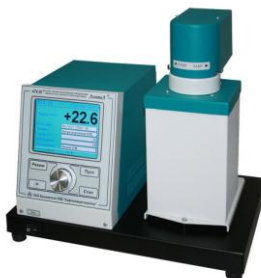
Рис. 12. Прибор для определения хрупкости битума
