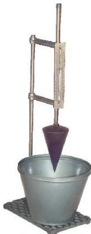
Рис. 6. Прибор для определения подвижности растворной смеси
