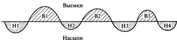
Рис. 3.3. Схема расположения выемок (В) и насыпей (Н) на автомобильной дороге (к контрольной задаче № 4)
