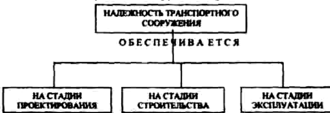
Рис.6.1. Комплексный подход к обеспечению надежности транспортного сооружения
