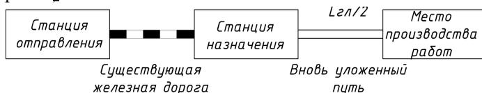
Рис. 1. Схема доставки балласта к месту выполнения работ
